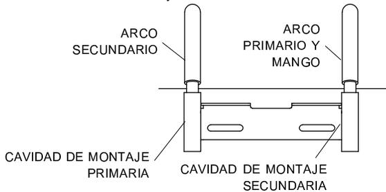
**PASO 7:** Ajuste los soportes de arco verticalmente para dejar 3" a 6" entre el doblado del mango y el punto donde la lona estará en contacto con el arco.
