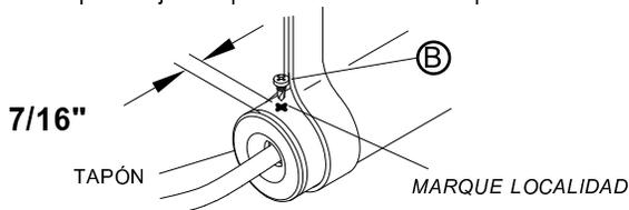
**PASO 5:** Taladre un agujero de 11/32" en la placa de cierre a 1 1/2" del borde de la lona. Inserte el tornillo de ojo Z y asegúrelo con la tuerca O y tuerca de bloqueo P.
