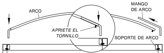
**PASO 5:** Ajuste los soportes de arco verticalmente para dejar 3" a 6" entre el doblado del mango y el punto donde la lona estará en contacto con el arco.
