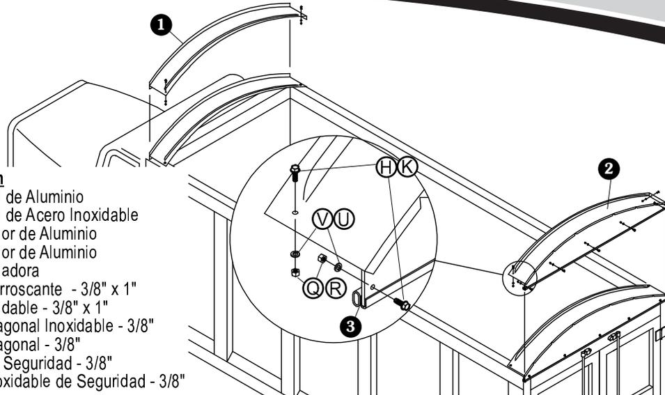
**PASO 1: Modificar tapas.** Coloque la tapa frontal c/rompe viento en la parte frontal de la caja. Coloque la tapa posterior en la parte posterior de la caja. Si es necesario modifique las tapas para que encajen en su caja.
