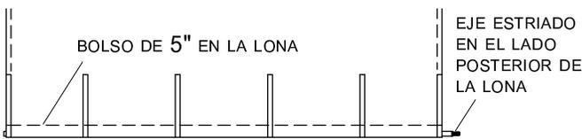
**CONSEJO:** Para facilitar la medida del tubo rotativo se puede inflar el bolso con una mandril neumático. Para mejor manejo, enrolle la lona en el tubo rotativo completamente antes de colocar el conjunto de lona y tubo en la caja.
