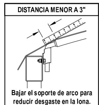
**PASO 7:** Marque y taladre agujeros de 5/16", fije los soportes con tornillos (H), arandelas (V) y tuercas (R) (tornillo (K), arandelas (W), arandelas (U) y tuercas (Q) para cajas de acero inoxidable).
