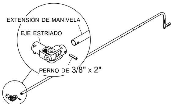
**PASO 4:** Coloque el "U-Joint" en el eje estriado. Asegúrelo con el pasador.
