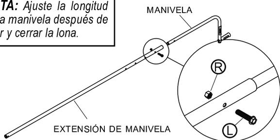
**PASO 3:** Inserte la extensión de manivela al "U-joint". Fije con el perno de 3/8" x 2".
