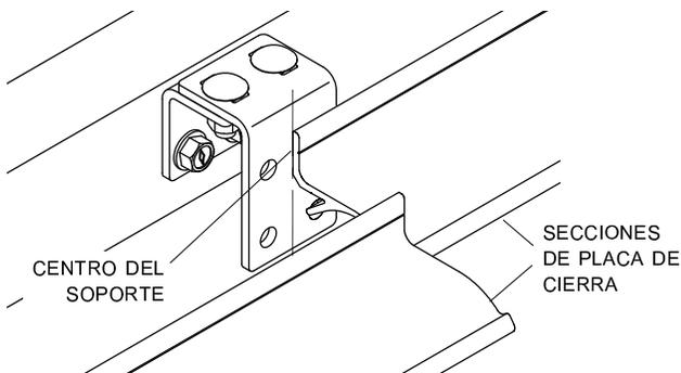
**PASO 2:** Alinee los agujeros centrales del soporte del tope con los agujeros inferiores en el soporte offset. Fije el soporte de topes al soporte offset con los tornillos **H**, arandelas **V** y tuercas **R**.
