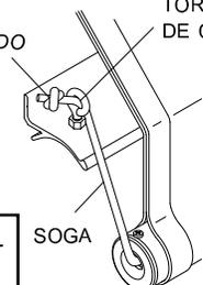
**CONSEJO:** No corte el exceso de soga hasta asegurar que la lona abra completamente.
