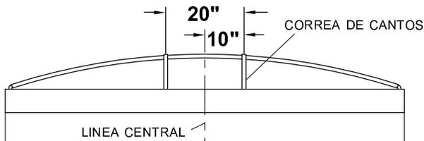
**PASO 2:** Instale la correa de canto sobre los arcos, posicione el trinquete por debajo de la correa como mostrado. Posicione la correa de canto por debajo del primer arco para las tapas de lona.
