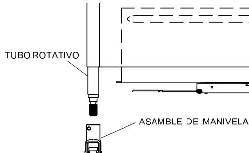
**PASO 8:** Deslice el bucle del retorno de cable por encima del tubo rotativo y reinstale la asamblea de manivela.
