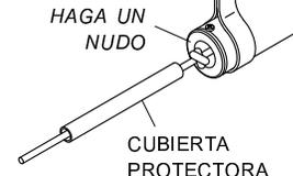
**PASO 8:** Inserte la cuerda elástica en el tornillo de ojo, aplique suficiente tensión para que casi se levante el tubo rotativo. Haga un nudo en la cuerda elástica en el tornillo de ojo.
