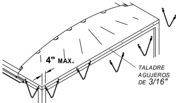
**PASO 3:** Coloque las anclas para la soga para que las cuerdas elásticas reciban por lo menos 10 libras de presión para jalarlas hacia abajo. Taladre agujero de 1/4" y sujete las anclas para la soga con los tornillos G y tuercas P.
