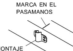
**PASO 4:** Coloque el arco en el soporte de arco. Coloque el mango de arco restante en el soporte de arco opuesto.
