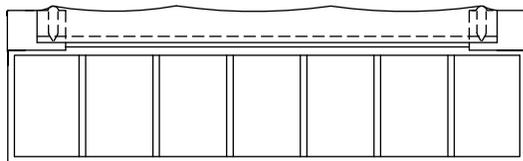
**NOTA:** Si la apertura de la lona será hacia el lado del conductor instale los topes en el pasamanos en el lado del conductor.
