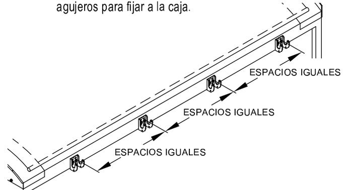
**PASO 5:** Usando los soportes de tope como machorra para marcar los agujeros a taladrar. Taladre agujeros de 5/16" y fije con tornillos (H), arandelas (V) y tuercas (R).
