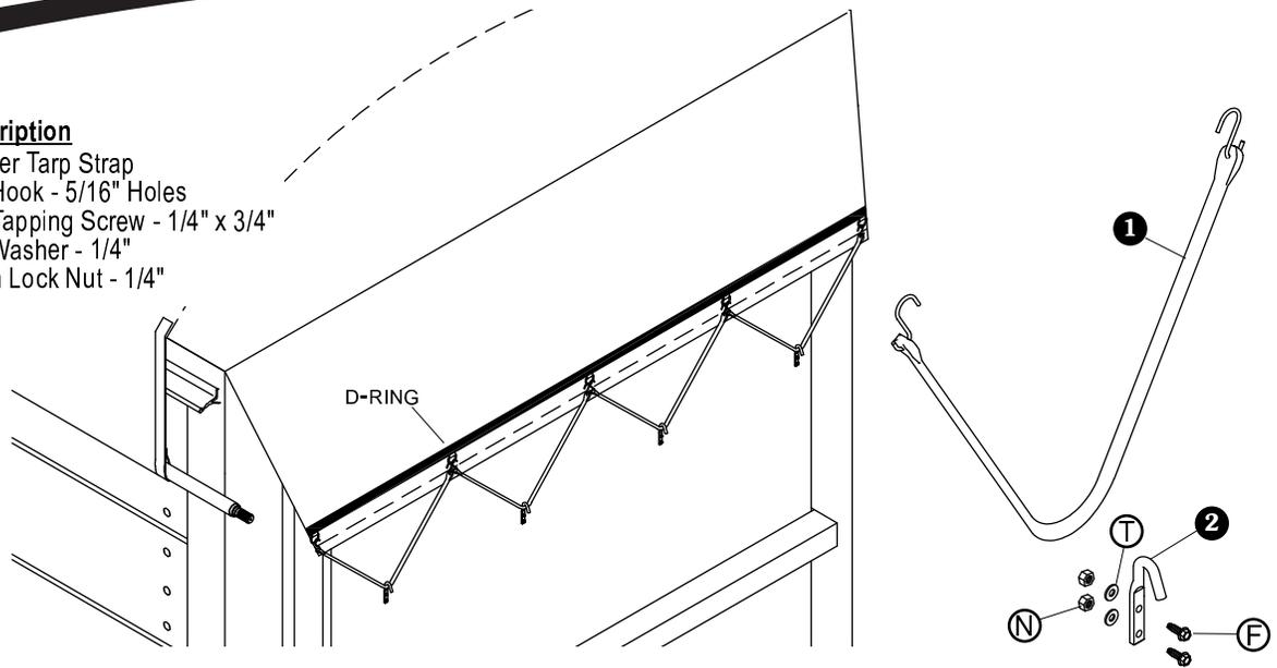
**PASO 1:** Instale el arco posterior y los soportes de arco en base a las instrucciones, colocando el arco lo mas cercano a la bisagra sin interferir con la apertura. Alinee el arco y la altura a la altura de los arcos previamente instalados.
