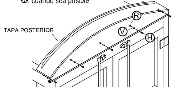
**PASO 4: Instale las tapas.** Taladre agujero de 5/16" (13/32") y sujete tornillo H cerca de tubo de cercha en el pliegue de 2". Asegure con la arandela de seguridad V y la tuerca R, cuando sea posible.
