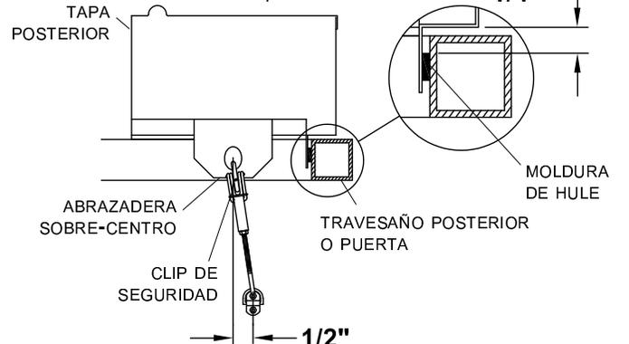
**PASO 9:** Marque y taladre agujeros de 1/4". Atornille las placas para Anillo-D a la caja con tornillos G y tuercas P. Apriete la contratuerca contra la abrazadera sobre-centro y la coloque el clip de seguridad.
