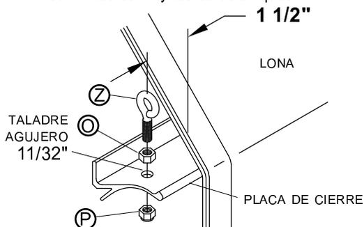
**PASO 6:** Con la lona cerrada y colgando sobre el borde de la caja, jale la cuerda elástica hasta que empieza a tener resistencia.
