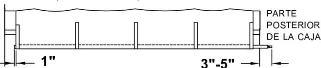
**PASO 5:** Centre la primera abrazadera-U en la correa frontal de la lona, fije con el tornillo D en el pliegue del bolso de la lona. Fije la abrazadera-U con el tornillo D.
