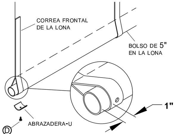
**PASO 6:** Estire la lona a lo largo del tubo rotativo hasta que ambos lados de la lona sean igual. Instale la abrazadera-U en la correa posterior de la lona.
