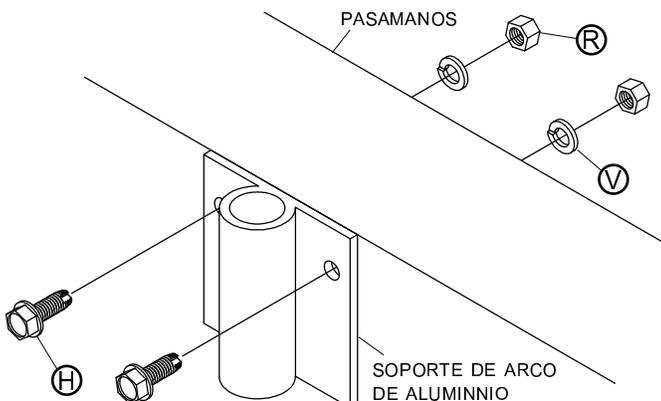
**PASO 3:** Inserte los arcos en los soportes de arco.
