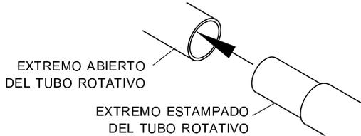
**PASO 2:** Corte el tubo rotativo 8" más largo que la lona (14" más largo si están usando tapas de lona) remueva el extremo estampado. Lije e inserte el tubo rotativo en el bolso de 5", con el eje estriado hacia la parte posterior de la caja.
