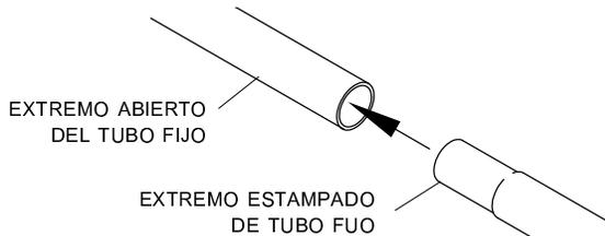
**PASO 3:** Inserte el tapon al extremo abierto del tubo fijo. Inserte el tubo, por lado del tapon primero, dentro del bolso de 4" en la lona.
