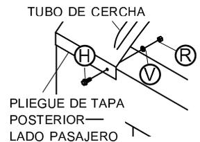
**NOTA:** Para el escurrimiento óptimo del agua y apoyo de la lona, asegúrese que las tapas sean niveladas antes de fijar los lados de las tapas a la caja. Mientras sujetan los lados de las tapas a la caja, eleven la tapa en el centro del lado del tubo de cercha al mismo nivel o ligeramente más arriba del borde exterior.
