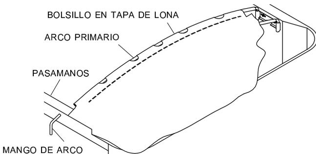
**PASO 10:** Corte las pletinas de aluminio 1/2" mas cortas que el bolsillo de la tapa de lona. Inserte las secciones en el bolsillo. Forme la pletina justo al radio de las esquinas de los pasamanos si es requerido.
