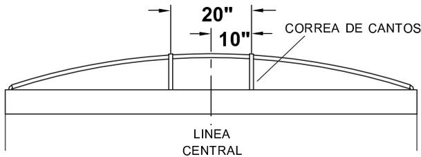
**PASO 2:** Coloque las correas de canto sobre los arcos, posicione los trinquetes por debajo las correas como mostrado.
