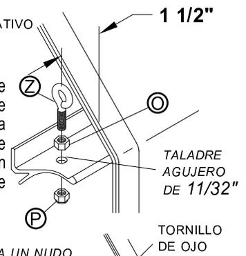
**PASO 7:** Inserte la soga del Shur-Return™ a través del tornillo de ojo, jale la soga hasta que quede justa y haga un nudo.
