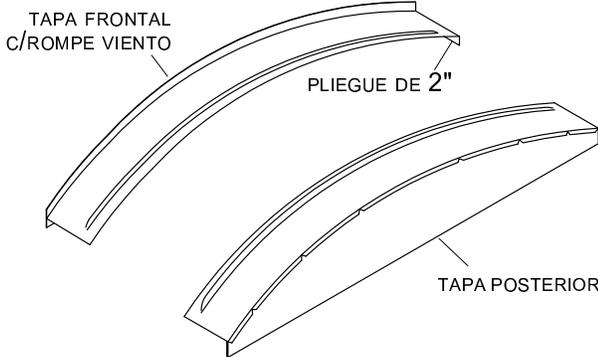
**NOTA:** Para instalaciones en cual la lona abre desde el lado del pasajero del remolque (rodado inverso), remueva el pliegue de 2" en el lado del pasajero de ambas tapas antes de la instalación.
