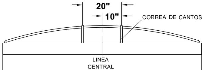
**PASO 2:** Coloque las correas de canto sobre los arcos, posicione los trinquetes por debajo las correas como mostrado.
