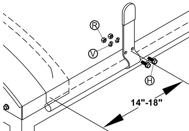
**PASO 3:** Cuadre y estreche la lona, coloque el segundo tope de 14" a 18" del frente de la lona. Coloque el tope sobre el tubo fijo y fije a la caja con tornillos (H), arandelas (V) y tuercas (R).
