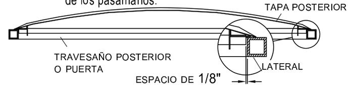
**PASO 7:** Quite la tapa y aplique la moldura de hule 1/4" por debajo de la parte plana de la tapa arriba del pliegue.
