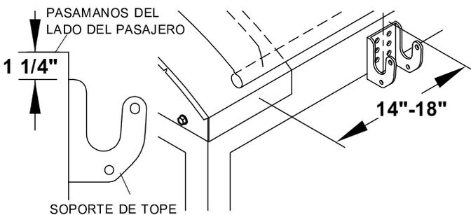
**NOTA:** Instale el soporte de tope en una superficie vertical. Fije el soporte a través de los agujeros que mejor queden con la configuración del pasamanos.
