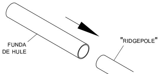
**PASO 4:** Inserte el "Ridgepole" en el bolso de "Ridgepole" en la lona. Centre el tubo en el bolso y verifique que el "Ridgepole" sea 1" menos corto que la longitud de la lona en cada lado.
