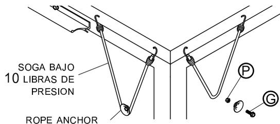
**Metodo alternativo:** Taladre un agujero de 5/16" atravesando la platina de aluminio y sujete la tapa a la caja con los tornillos G. Instale dos tornillos G en cada lado de la tapa y distribuya los tornillos sobrantes con distancias iguales.
