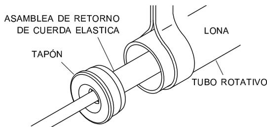
**PASO 4:** Marque el tubo rotativo aproximadamente 7/16" del borde del tapón. Fije el tapón con el tornillo autopercutor B.
