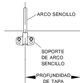
**PASO 12:** Instale la tapa de lona en la misma manera que la frontal fue instalada usando el soporte de arco sencillo y un arco. No soldé el mango restante al arco.
