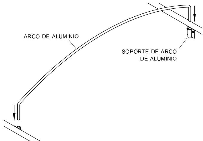
**NOTA:** Es importante medir la caja en cada localización de los arcos porque la caja puede tener variaciones entre la anchura del frente hacia atrás y los arcos de aluminio solido no se pueden cortar para ajustar anchura.
