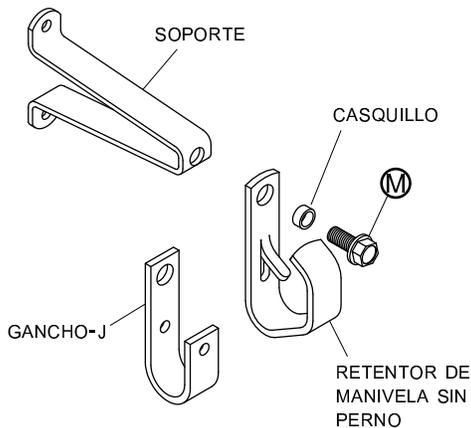
**PASO 2:** Determine la localidad del retenedor en la parte posterior de la compuerta quedando más arriba de la manivela.
