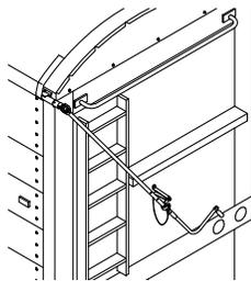
**PASO 3:** Revise la tensión de la lona. Debe tomar entre 40 y 60 libras de fuerza para colocar la manivela en el retenedor. La extensión de la manivela se curveara 1/8".
