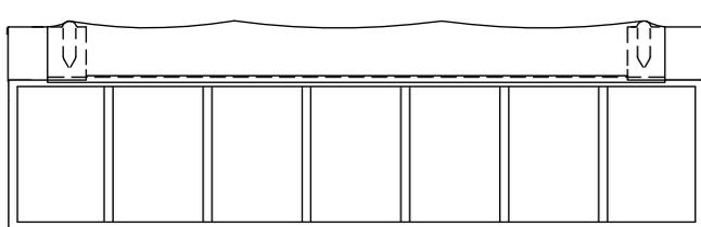
**NOTA:** Si la apertura de la lona será hacia el lado del conductor instale los topes en el pasamanos en el lado del conductor.
