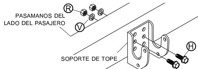
**PASO 6:** Ajuste la lona para que el tubo fijo quede cuadrado en los soportes de tope. Fije los topes de aluminio con el pasador de horquilla y chaveta.
