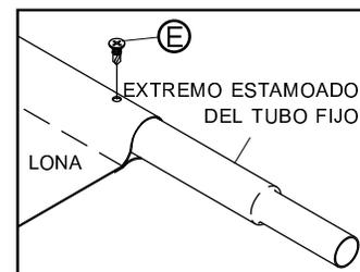
**PASO 6:** Corte el tubo fijo a 1/4" pasando el borde de la lona, remueva el tubo estampado, lije las rebabas.
