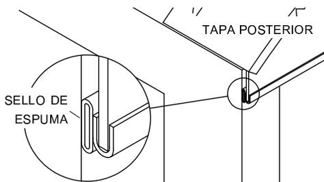
**NOTA:** En los pasos 3 a 5 para tapas de acero inoxidable, taladre agujeros de 3/32" y sujete con tornillos K, arandelas de seguridad U y tuercas Q.
