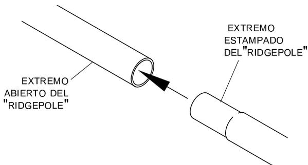
**PASO 2:** Corte el "Ridgepole" 2" mas corto que la longitud de la lona. Lije los bordes.
