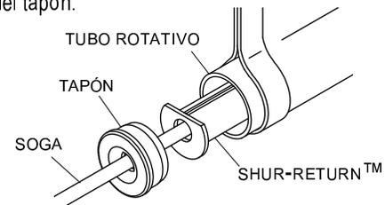
**PASO 5:** Ligeramente golpee el tapón hasta que asiente en el tubo rotativo. Marque el tubo rotativo a 7/16" del borde del tapón y fije el tapon con el tornillo **B**.
