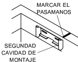
**PASO 4:** Coloque el arco en el soporte de arco. Coloque el mango de arco restante en el soporte de arco opuesto.
