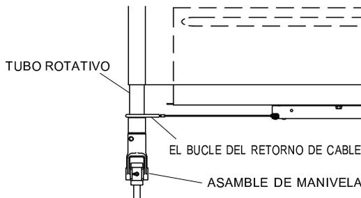
**PASO 1:** Detenga la manivela firmemente con ambas manos y enrolle la lona a la posición cerrada bajo el placa de cierre. Baje la manivela directamente hacia abajo perpendicular al piso.
