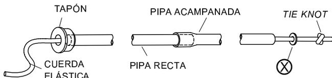
**PASO 3:** Inserte la asamblea de retorno de cuerda elástica dentro del tubo rotativo. Ligeramente golpee el tapón hasta que asiente en el tubo rotativo.
