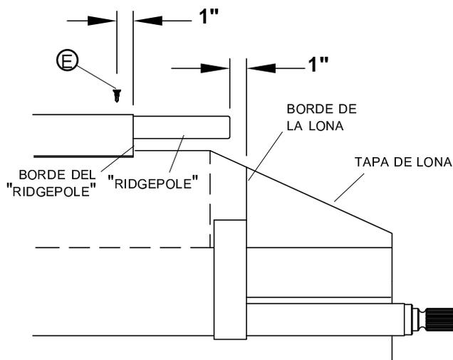
**PASO 5:** Instale el tornillo E 1" del borde del bolso. Jale la lona la longitud completa e instale el segundo tornillo en el lado opuesto del tubo.
