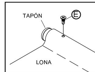
**PASO 5:** Estire la lona a lo largo del tubo fijo y asegure con un tornillo E.
