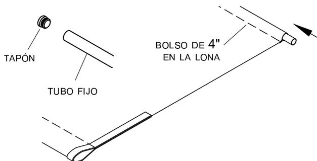
**PASO 4:** Extienda el tubo fijo 1/4" pasando el borde de la lona. Sujete la lona al tubo fijo con el tornillo E.
