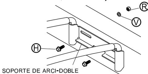
**PASO 9:** Remueva el arco primario y el mango del soporte. Instale la tapa de lona en el arco. Deje que la lona cuelgue sobre los pasamanos y el frente de la caja.
