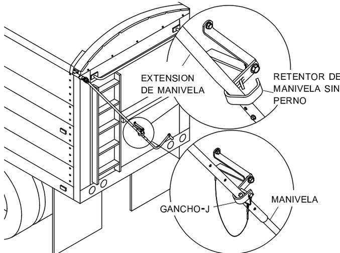
**PASO 3:** Marque y taladre agujeros de 5/16" y fije los retenedores a la caja con tornillos (H), arandelas (V) y tuercas (R). Ensamble el pasador con el cable. Fije el cable entre la caja y el soporte con el tornillo (M).
