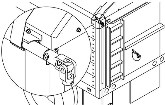
**PASO 2:** Estreche la lona al levantar la manivela y colocándola en el retenedor.
