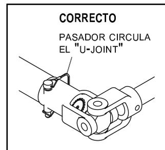
**NOTA:** El "U-joint" está diseñado para operar como mostrado en el lado derecho y aguanta más presión en esta posición.
