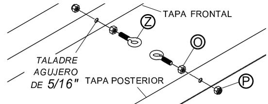
**PASO 4:** Enganche la correa de canto y trinquete en los tornillos de ojo en las tapas. Coloque el trinquete debajo de la correa para prevenir desgaste.
