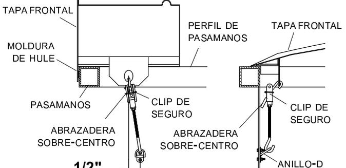
**PASO 5:** Marque y taladre agujeros de 1/4". Atornille las placas para Anillo-D a la caja con tornillos G y tuercas P. Apriete la contratuerca contra la abrazadera sobre-centro y la coloque el clip de seguridad.
