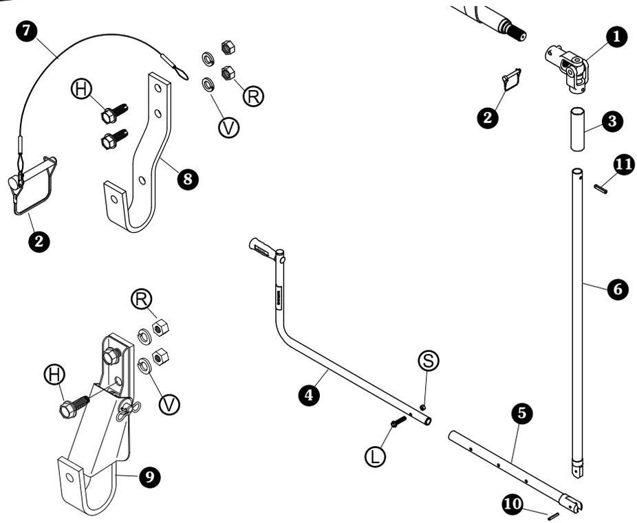
**PASO 1:** Deslice el tubo de extension superior y despues fije el U-joint con el perno.
