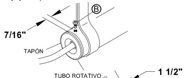
**PASO 6:** Taladre un agujero de 11/32" en la placa de cierre a 1 1/2" del borde de la lona. Inserte el tornillo de ojo **Z** y asegúrelo con la tuerca **O** y tuerca de bloqueo **P**.
