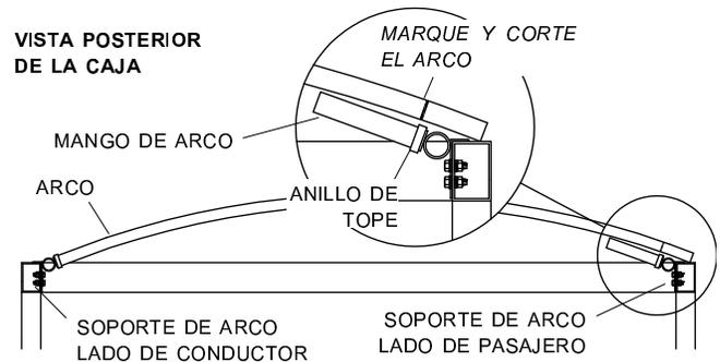
**PASO 4:** Sujete el arco a los soportes con los pernos de arco. Asegure con el pasador clavija.
