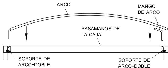
**PASO 5:** Alinear arco con el mango de arco. Marcar el arco en el punto donde la curva comienza el mango. Corte los dos arcos a esta longitud.
