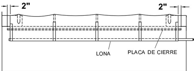
**NOTA:** Si la apertura de la lona será hacia el lado del conductor instale la placa de cierre en el lado del pasajero.
