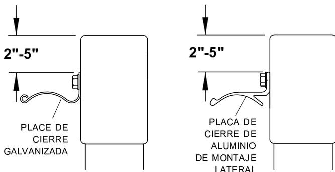
**PASO 2B:** Placa de cierre de montaje superior. Instale en la misma manera de la placa de montaje lateral, con la excepción de fijar sobre el pasamanos y alineando los tornillos a 1 3/16" del borde del pasamanos.
