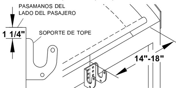
**PASO 4:** Coloque el resto de los soportes de tope con espacios iguales y alineados verticalmente. Marque y taladre para fijar a la caja.
