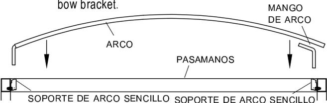
**PASO 5:** Alinear arco con el mango de arco. Marcar el arco en el punto donde la curva comienza el mango. Lije la rebaba y solde el mango al arco.
